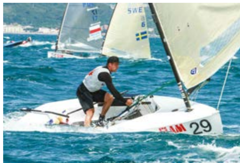
При более сильных ветре и волнении рулевому часто требуется упереться ногой с наветренной стороны яхты и перенести на нее свой вес, чтобы потом сделать эффективный гребок.
